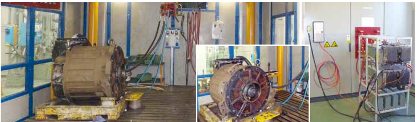
Banco prova motori di trazione asincroni
