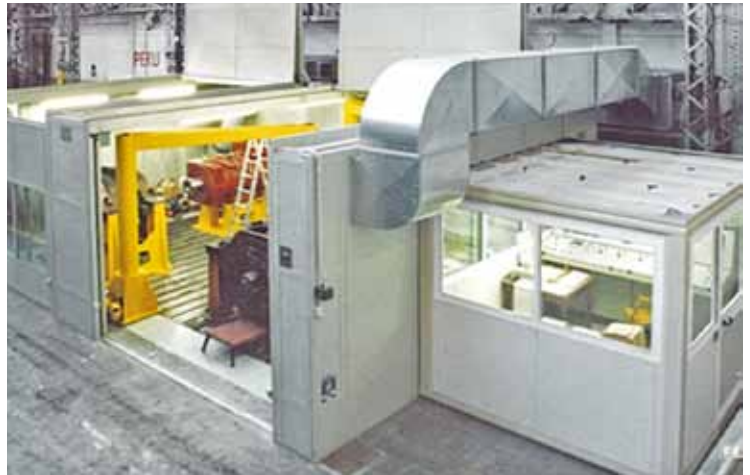
Banc d'essai moteurs AC/DC
