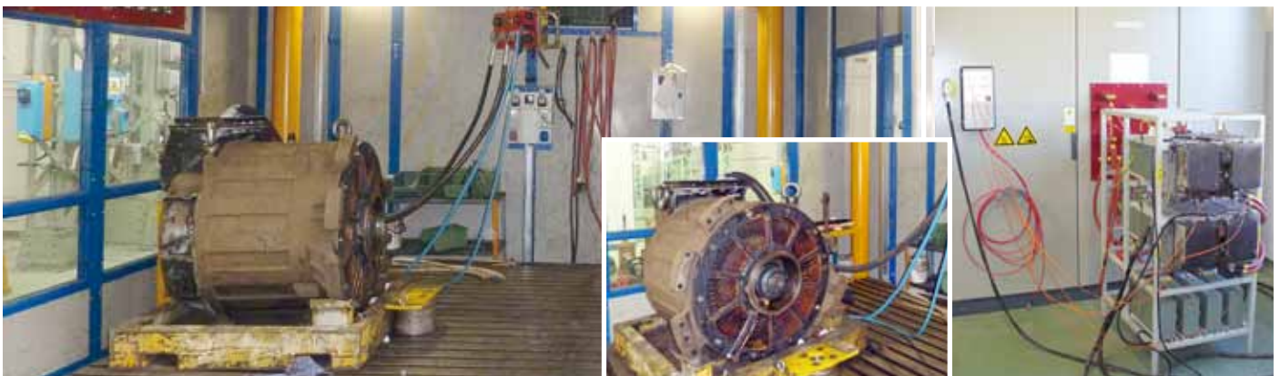
Banco de pruebas: motores de tracción asíncronos
