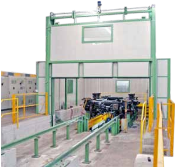
Banco de pruebas: rotación de bogies
